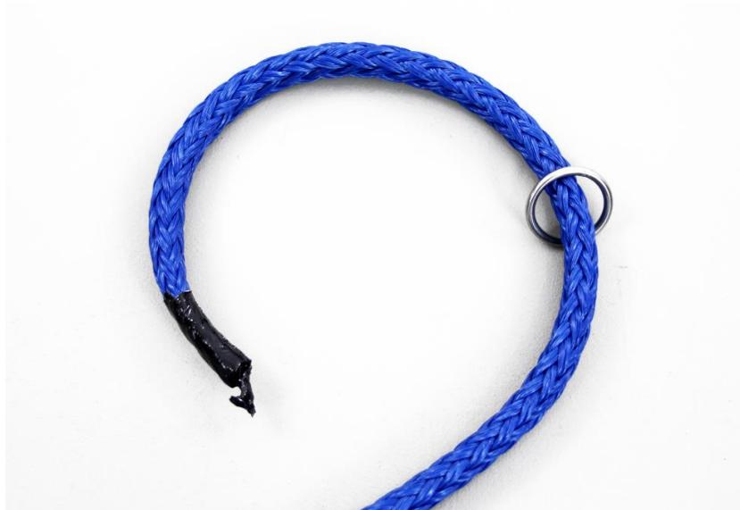
**... das abgeklebte Ende des Hohlgeflechts genau dort, wo der Ring nachher sitzen soll, durchstecken, ...**
